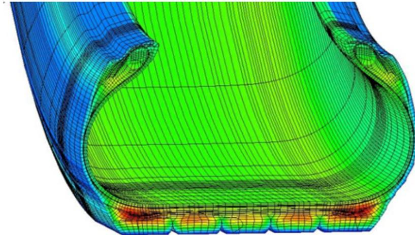
En condiciones idénticas de carga (4.500 kg), de presión (9 bar) y de velocidad (100 km/h), este nuevo compuesto se calienta menos (alrededor 6° C menos), lo que permite de reducir la resistencia a la rodadura y, por lo tanto, el consumo de carburante y las emisiones de CO<sub>2</sub>, comparado con un neumático de la generación anterior.
