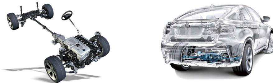
Además, el sistema BMW xDrive puede distribuir el 100% de la potencia del motor al eje adecuado a través de la transmisión y el embrague electrónico multidisco, antes de regresar a una distribución convencional, de proporción 40:60. El resultado es una detección a tiempo de sobreviraje y subviraje que garantiza la conducción más segura posible incluso en los terrenos más difíciles.
