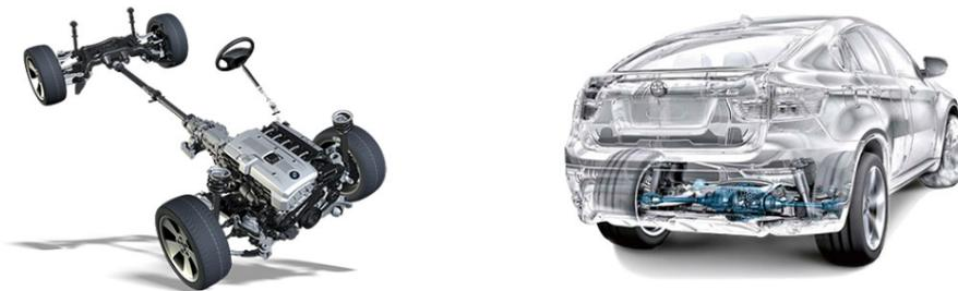
Além disso, o sistema BMW xDrive pode distribuir 100% da potência do motor ao eixo adequado através da transmissão e da embraiagem eletrónica multidisco, antes de regressar a uma distribuição convencional, de proporção 40:60. O resultado é uma deteção a tempo de sobreviragem e subviragem que garante a condução mais segura possível inclusive nos terrenos mais difíceis.
