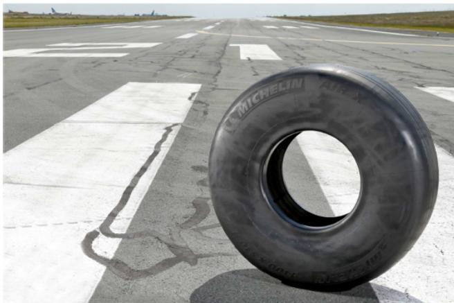
Comparado con un neumático radial de nylon equivalente, este nuevo neumático proporciona hasta un 10% menos de peso, un 30% más de aterrizajes y un 30% adicional de resistencia a las agresiones (FOD). De este modo, Michelin contribuye a ofrecer a una movilidad más segura y más eficiente a las compañías aéreas y usuarios que utilicen el Airbus A350-XWB.
