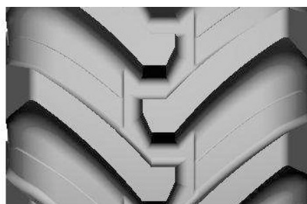
Pneu MICHELIN da geração anterior. Percentagem de marca vazia = 71%
