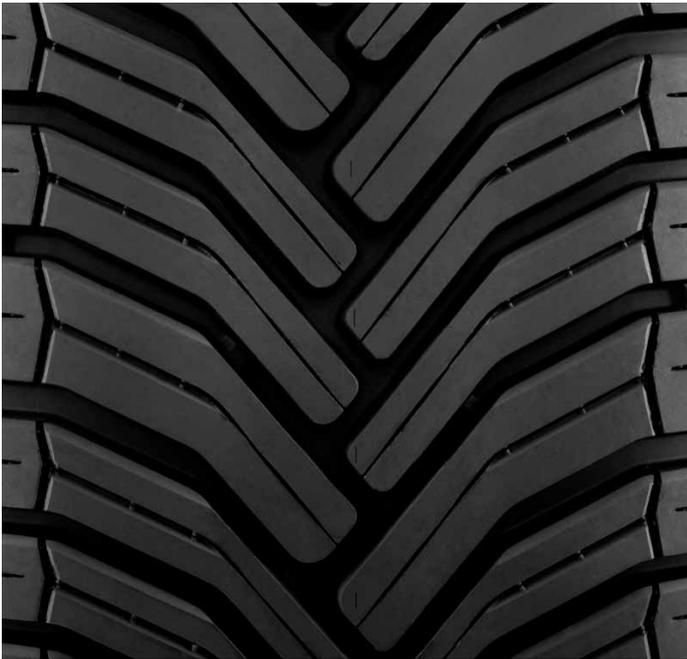
**3.** Esta escultura em V combina-se com as novas lamelas 3D com autobloqueio: extremamente onduladas, de uma espessura variável e geometria complexa, estas lamelas de total profundidade provocam um efeito de "garra" sobre a neve e, deste modo, melhoram a tração.
