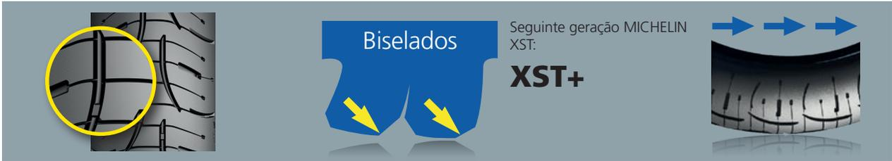
• Uma **percentagem de estrias variável**, que permite oferecer uma aderência ótima em qualquer grau de inclinação da moto.
