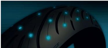
• A **tecnologia MICHELIN XST**, que se caracteriza por um design muito inovador da banda de rolamento, combina lamelas e espaços. Isto permite simultaneamente romper a película de água, aumentar a capacidade de drenagem e encontrar, assim, as condições de aderência de uma estrada quase seca.
