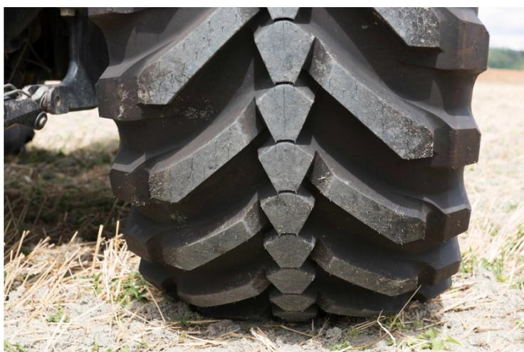
Esta transformación es el resultado del diseño innovador de una nueva carcasa que, además de beneficiarse de la tecnología Ultraflex, integra un "efecto bisagra", que permite que el área del hombro se eleve o se extienda sobre el terreno. A baja presión, la superficie de la huella aumenta en un 20 %. Estas ventajas se combinan con una tracción optimizada, una mejor transmisión de la potencia y una menor compactación del suelo.
