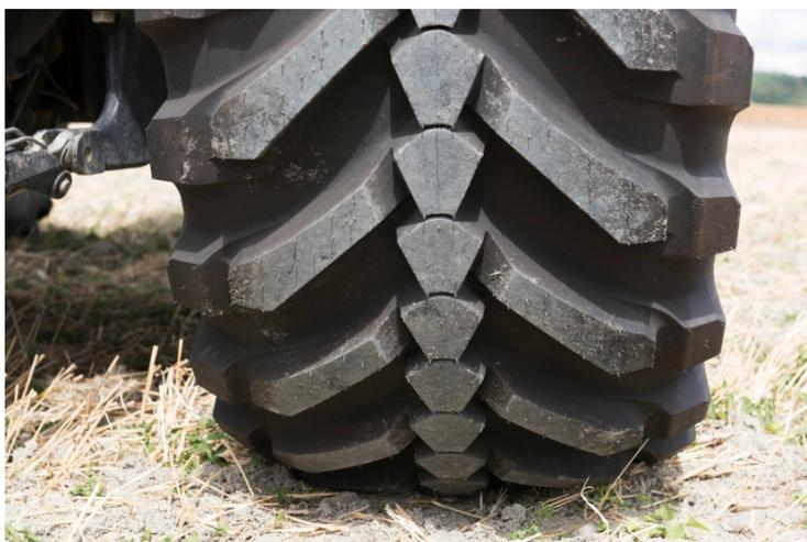
Esta transformação é o resultado do design inovador de uma nova carcaça que, além de beneficiar da tecnologia Ultraflex, integra um “efeito dobradiça”, que permite que a área do ombro se eleve ou se estenda sobre o terreno. A baixa pressão a superfície da marca aumenta cerca de 20%. Estas vantagens combinam-se com uma tração otimizada, uma melhor transmissão da potência e menos compactação do terreno.
