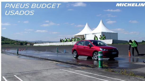
é que a economia do combustível do veículo melhorará – a resistência ao rolamento de um pneu no momento da remoção no limite de piso legal é de 80 por cento desse pneu em estado novo. Por isso, manter um pneu no veículo até ao limite legal de profundidade de piso aumenta o tempo em que se encontra no seu estado mais eficiente, reduzindo o consumo de combustível do condutor.
