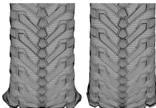
BAJA PRESIÓN ALTA PRESIÓN Huella aumentada en un 20 %, a lo ancho y a lo largo
