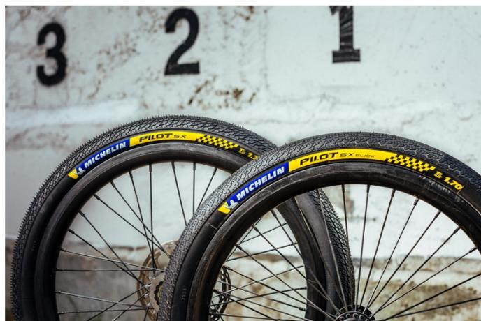
Ambos neumáticos son Tubeless ready (TLR) para reducir el peso y mejorar la resistencia a la rodadura entre un 15 y un 25 por ciento en comparación con el mismo neumático cuando se utiliza cámara. Sin embargo, como todos los neumáticos de bicicleta MICHELIN TLR, los nuevos neumáticos BMX Racing Line también pueden utilizarse con cámaras. Ambos modelos cuentan con una robusta carcasa de tres capas de 60 TPI para resistir los daños, mejorar la duración y rodar con presiones de hasta 5 bares.
