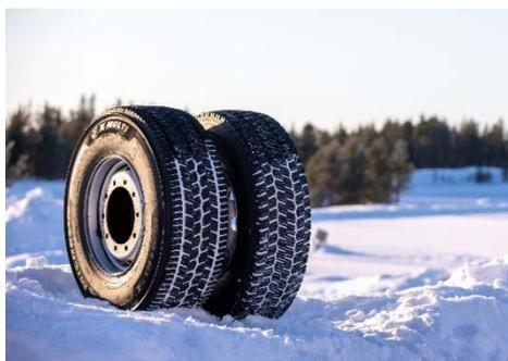
O inovador desenho da banda de rolamento, com lamelas evolutivas baseadas na tecnologia MICHELIN Regenion, proporciona uma excelente aderência, inclusivamente à medida que o pneu se desgasta. Com uma profundidade restante do piso de 5 mm, a tração sobre neve melhora 50%, e a travagem sobre neve 20%, face ao seu predecessor. Com 2 mm de profundidade restante do piso na banda de rolamento, a aderência transversal é 20%<sup>(2)</sup> melhor.
