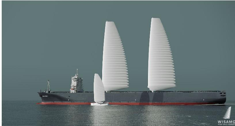
A vela possui uma ampla gama de utilização, particularmente quando se navega em bolina cerrada, e pode ser utilizada em todas as rotas marítimas. O seu mastro telescópico retráctil facilita a chegada aos portos, assim como a sua passagem sob as pontes. Permitirá uma melhoria da eficiência da embarcação, em termos de consumo de combustível, de até 20%\*.
